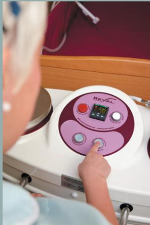
Positionnez l'appareil au bout du lit et sélectionnez une température sur le régulateur de température. Appuyez sur le bouton «chauffage» et attendez que l'appareil atteigne la température désirée (environ 12 min à partir d'eau froide)
